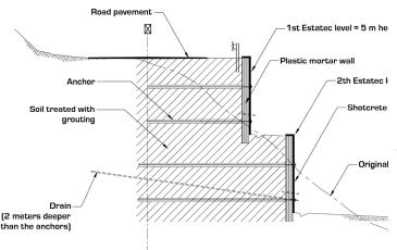
Fig. 4 Estatec Terrace Solution
