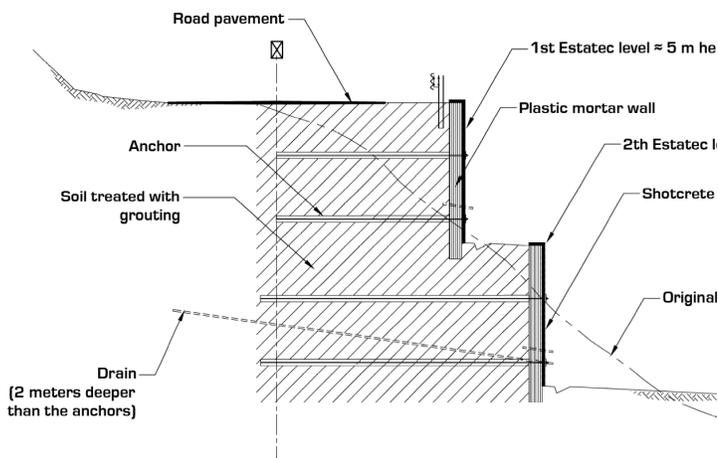
**Fig. 4 Estatec Terrace Solution**
